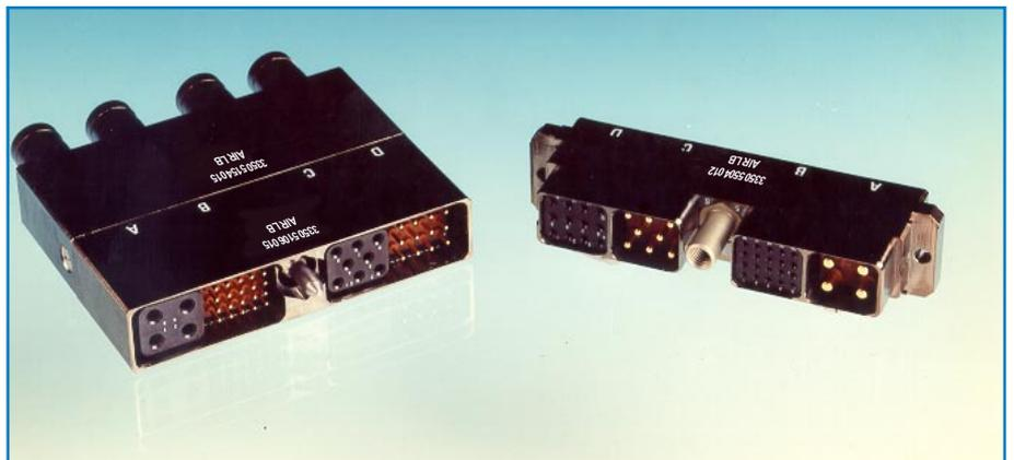
Ils sont insérés manuellement dans les compartiments du boîtier et extraits à l'aide d'un outil approprié.
